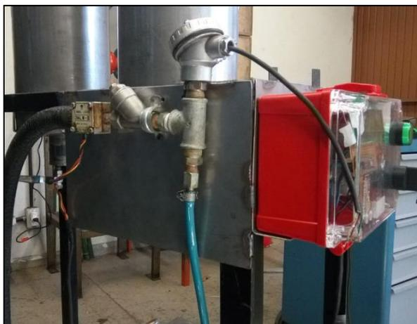
**Figura 13.** Sensor de medida da temperatura de saída.
