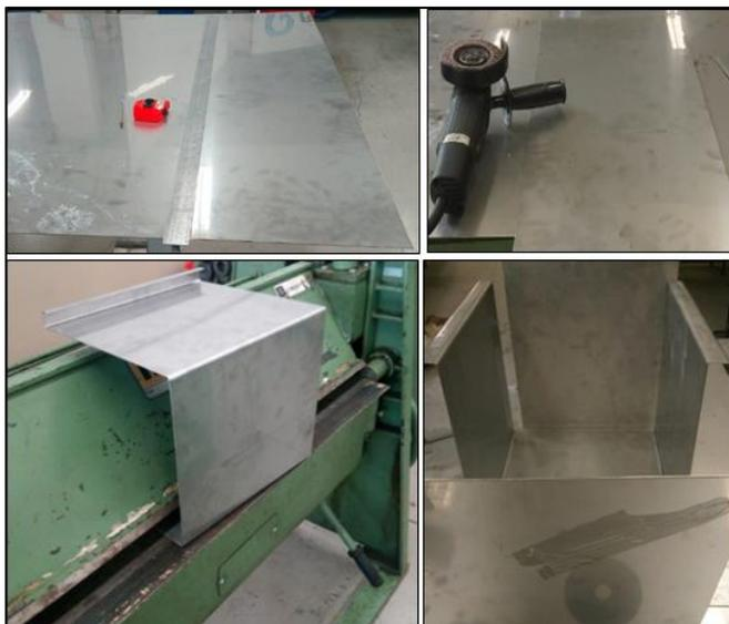
**Figura 20.** Processo de traçagem corte e dobra do reservatório de água.
