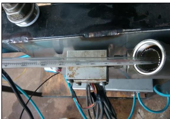
**Figura 35.** Termômetro inserido junto ao sensor de saída.
