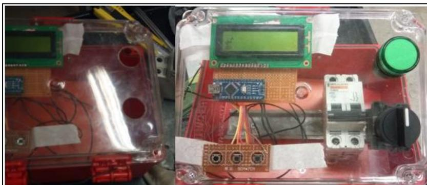
**Figura 16.** Furação de painel e componentes pré-fixados.
