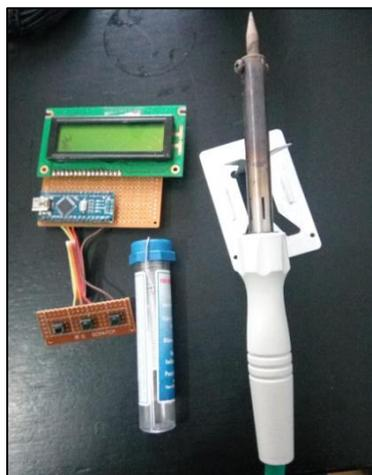
**Figura 17.** Ferro de solda e material de estanho usado na soldagem dos componentes eletrônicos.
