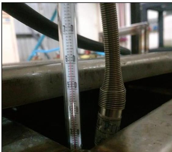
**Figura 33.** Termômetro e sensor de temperatura no reservatório de água.
