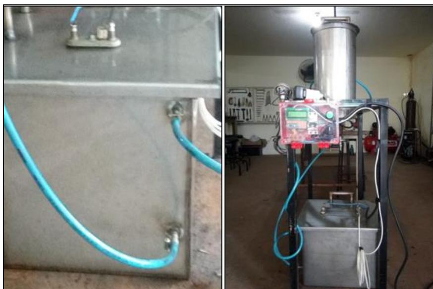
**Figura 24.** Ligação para deslocamento do combustível conforme circuito.
