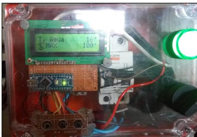
**Figura 26.** Configuração da temperatura da água e temperatura máxima.
