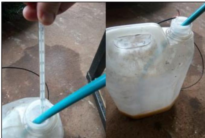
**Figura 36.** Termômetro inserido ao galão de óleo de retorno.
