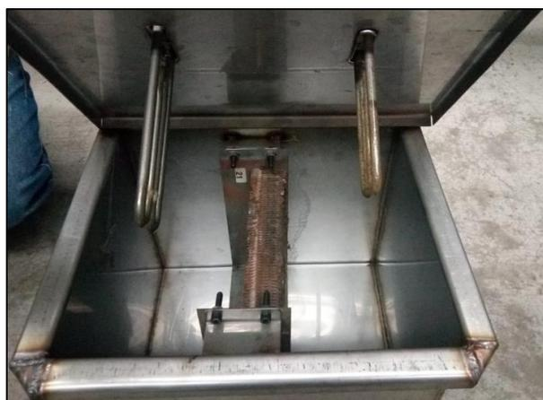
**Figura 22.** Radiador e resistências inseridos no reservatório.
