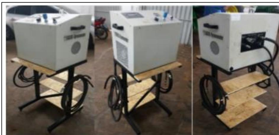
**Figura 31.** Fluxômetro EGGERS modelo FM3-100.
