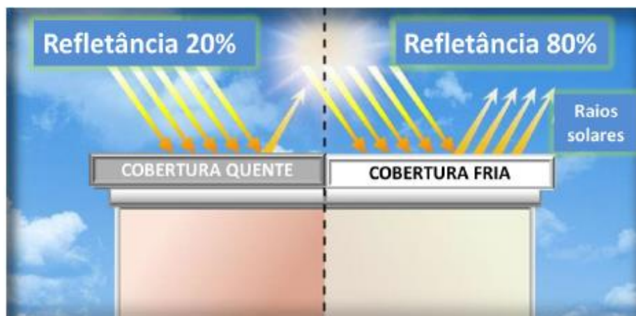
Figura 04: O efeito da refletância nas coberturas "frias" e convencionais Fonte: SILVA (2017)
