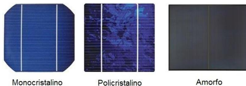
Figura 3. Tipos de células fotovoltaicas de Silício.
