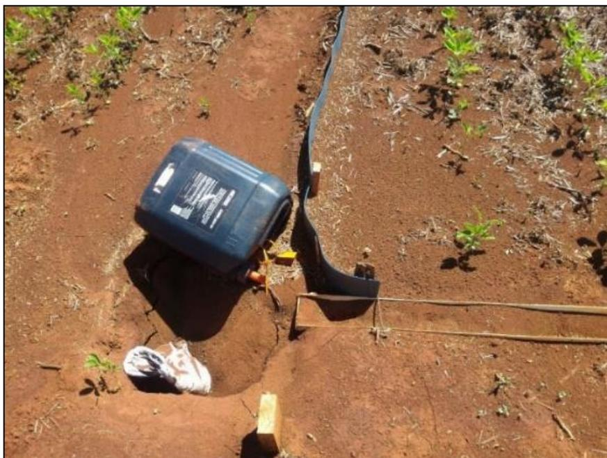
**Figura 9.** Calha entupida em dia de precipitação elevada.
