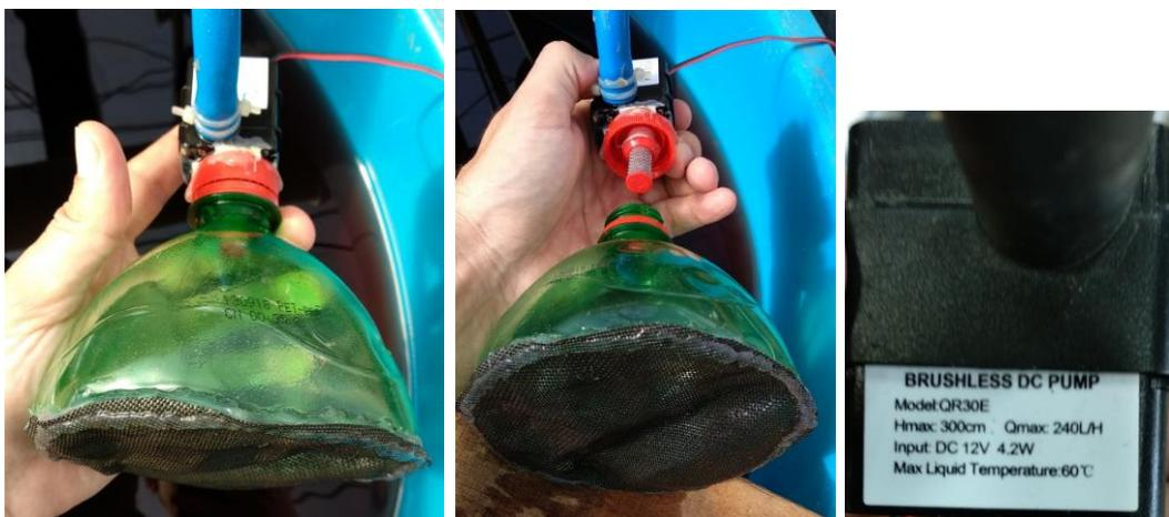
Figura 14 – Montagem de filtro para bomba 12V CC.
