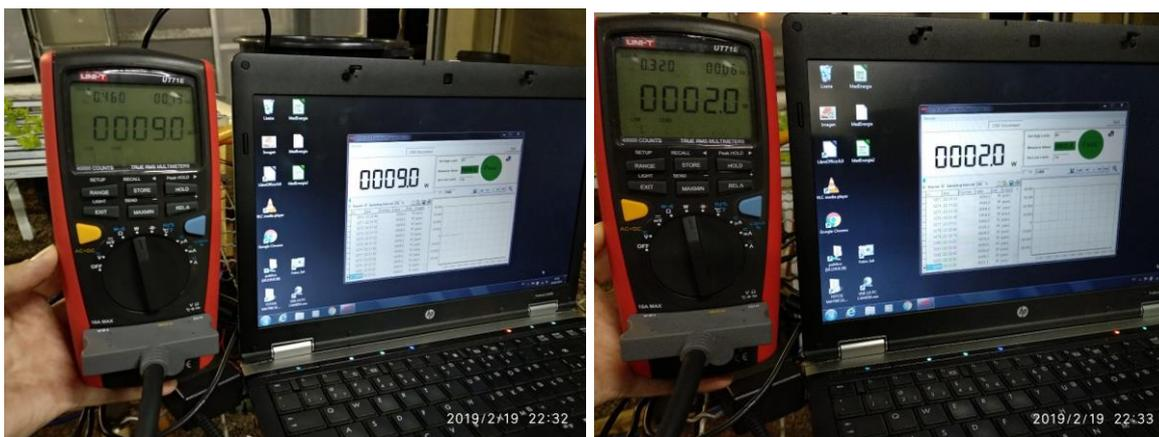
Figura 44 – Medições de energia com multímetro Unit-T UT71E, a) com a bomba ligada e b) com a bomba desligada.
