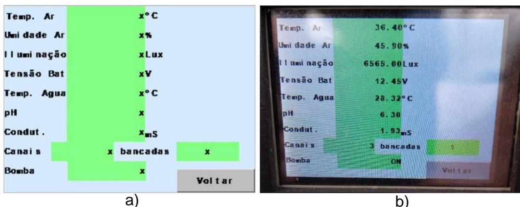
Figura 41 – a) Tela de status do sistema no software nextion e b) Tela de status real.
