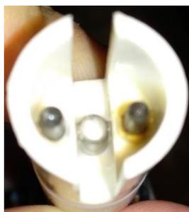
Figura 48 – Oxidação provocada pela ação salina da solução em volta dos eletrodos do condutivímetro.
