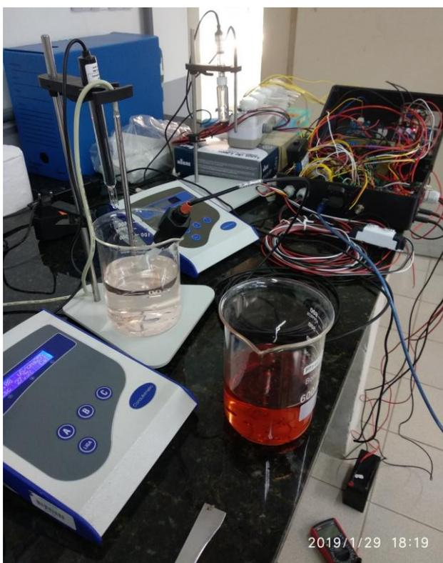
Figura 38 – Levantamento de resposta de sensor de condutividade do sistema automatizado em comparação com o de bancada.
