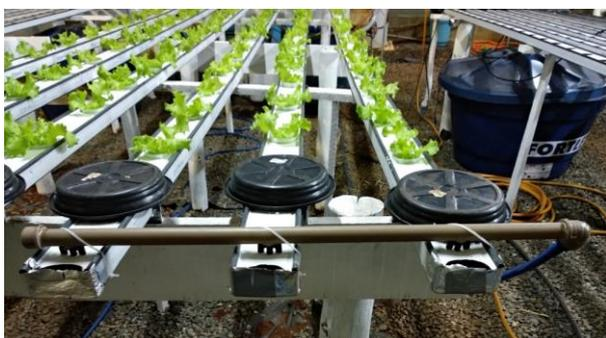
Figura 13 – Detalhe da entrada da solução nutritiva nos perfis do sistema automatizado.
