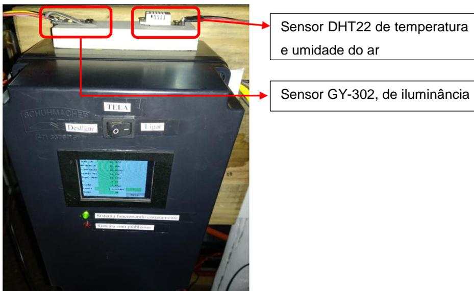
Figura 26 – Visão frontal e superior da caixa do sistema de automação.
