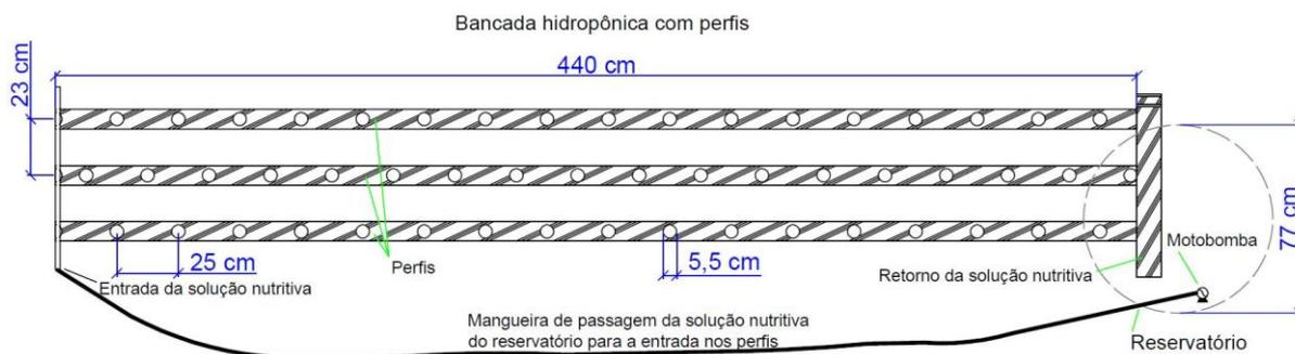
Figura 11 – Desenho esquemático da vista superior da bancada de teste.
