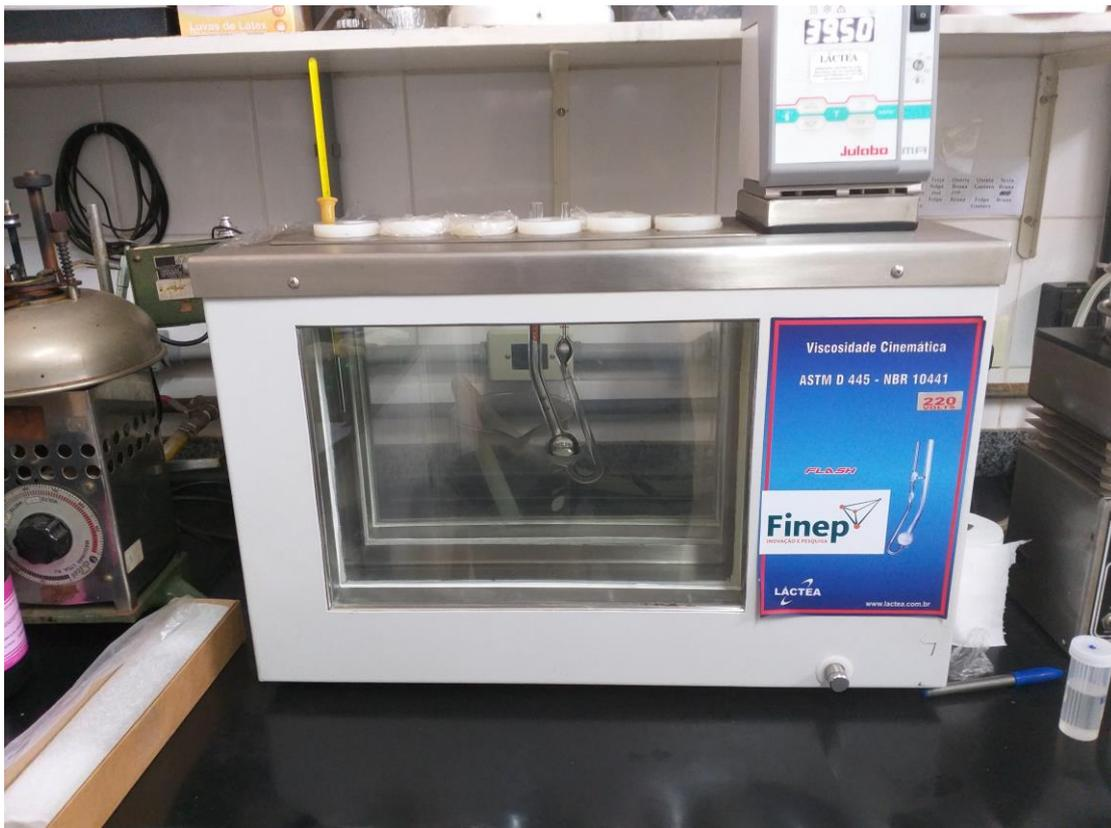
Figura 7 – Banho termostático a 40°C com viscosímetro capilar.
