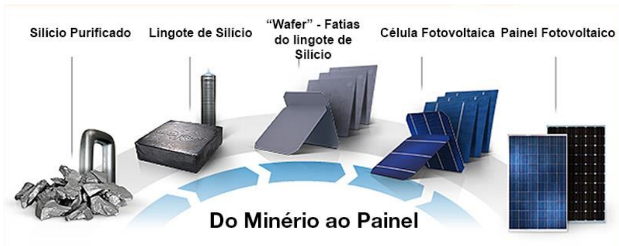
Figura 14 – Cadeia de produção dos painéis fotovoltaicos. Fonte: Portal Solar (2018).
