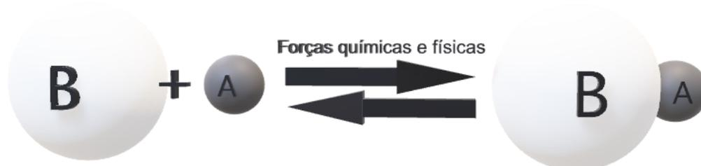
**Figura1.** Ilustração esquemática do processo de adsorção. A: adsorvato; B: superfície externa ou do poro do adsorvente.
