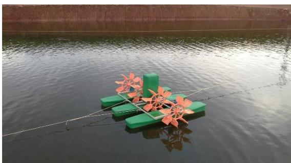
Figura 3 - Modelo de aerador de pás. Fonte: Sul Pesca (2018).
