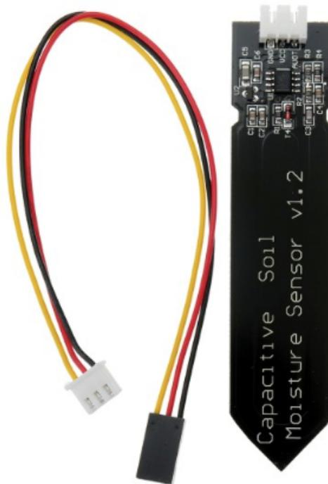
Figura 14 - Sensor de umidade - CS12
