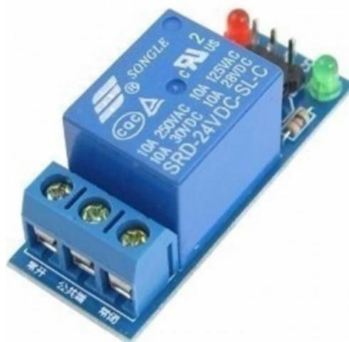
Figura 19 - Relé 1 canal 5V
