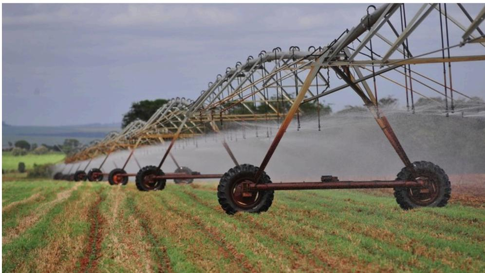
Figura 4 - Sistema de irrigação pivô-central
