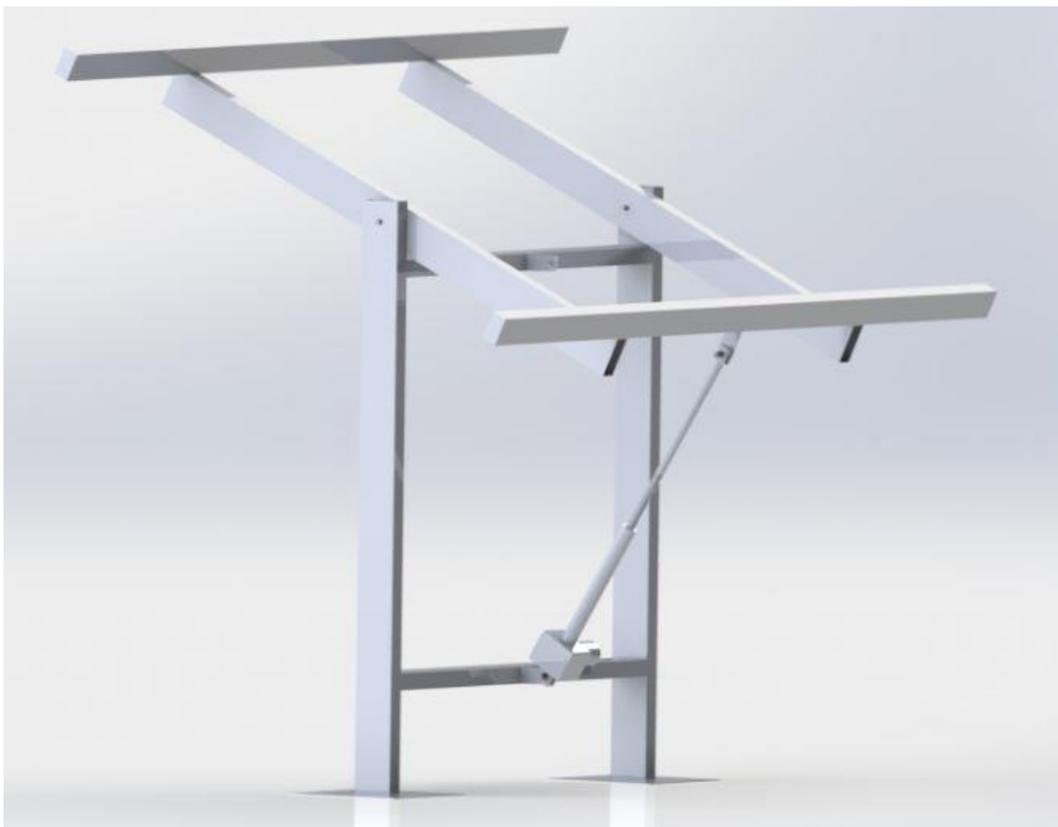
Figura 24 – Rastreador Solar de Um Eixo Renderizado.
