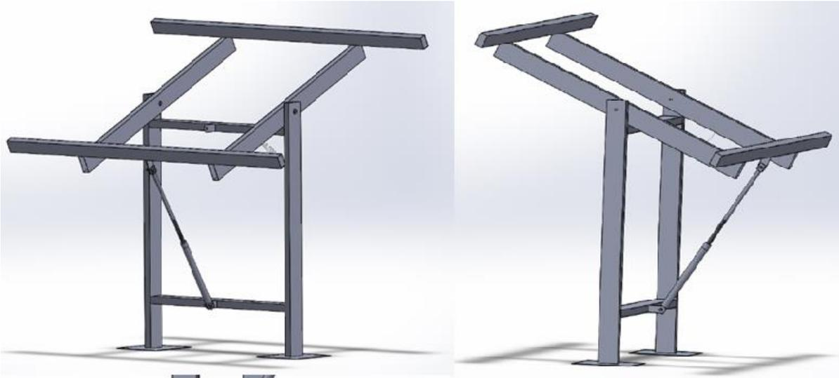
Figura 38 - Protótipo para Sistema Fotovoltaico de Um Eixo
