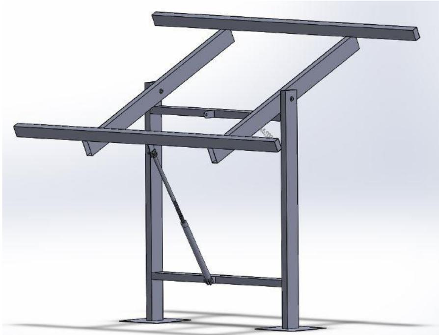
Figura 23 – Vista Isométrica Rastreador Solar de Um Eixo, modelado em software computacional.
