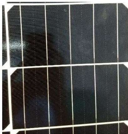
Figura 6 - Célula de silício monocristalino.
