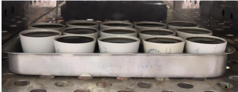
Figura 19 - Amostras de substratos em processo de secagem utilizando estufa com recirculação de ar
