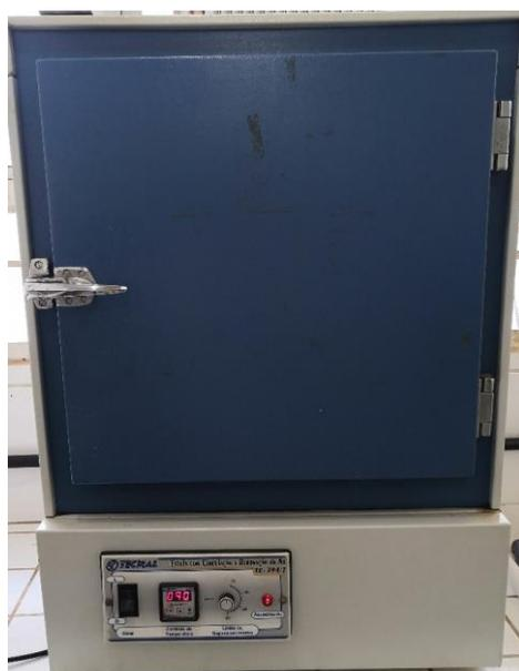
Figura 12 - Estufa com recirculação de ar para remoção de água das amostras
