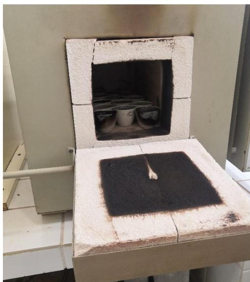
Figura 13 – Mufra utilizada para combustão da amostra seca
