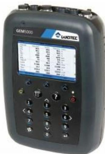
Figura 14 - Monitor de gás portátil modelo Landtec GEM 5000
