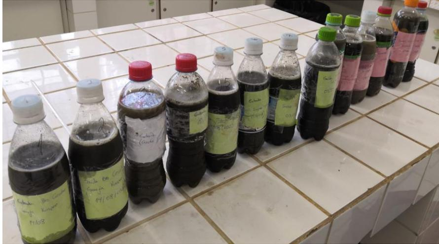
Figura 18 - Amostras de substrato preparadas para análise de sólidos
