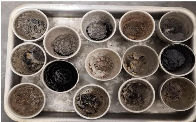
Figura 20 – Cinzas das amostras após processo de secagem e combustão em mufla
