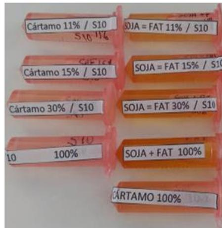
**Figura 9.** Amostras dos Combustíveis em microtubos
