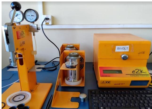
**Figura 10.** Bomba Calorimétrica.
