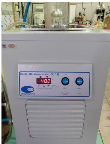
**Figura 13.** Ensaio da viscosidade cinemática
