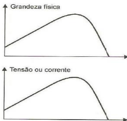
Figura 4 – Exemplo de resposta de um sensor com saída analógica.
