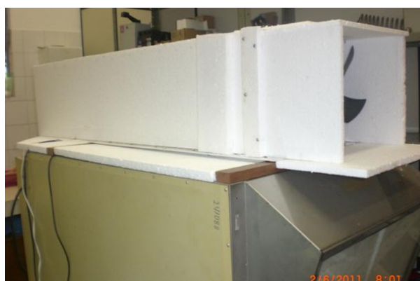
Figura 08 – Lado da entrada do túnel de vento.
