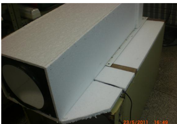
Figura 07 – Lado da saída do túnel de vento.
